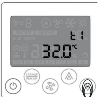
Стрелками «вверх» или «вниз» устанавливается необходимая температура. Переход к редактированию функции «скорость вентилятора» - нажать кнопку «вентилятор»
