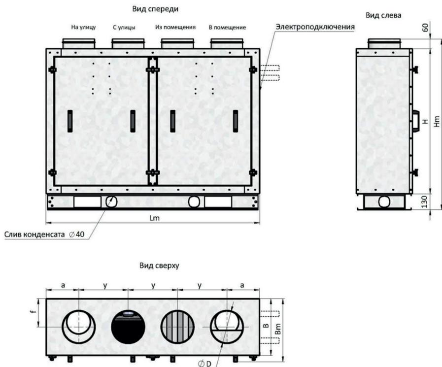
Пунктирной линией на чертеже обозначено расположение водяного нагревателя.
