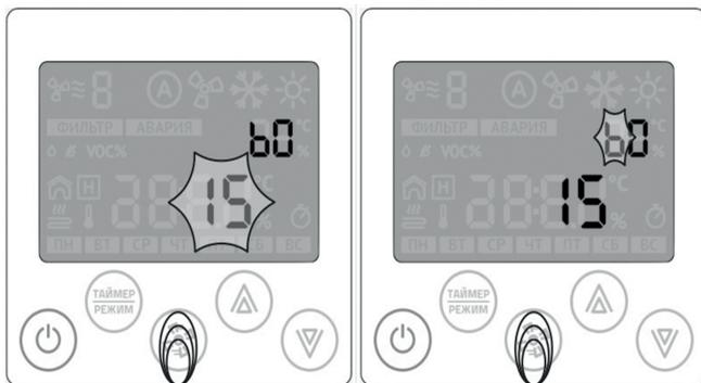
Кнопка «вентилятор» переключит выбора параметра на режим ввода значение параметра. Кнопка «вниз» или «вверх» будет менять значение выбранного параметра
