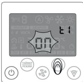
Стрелками «вверх» или «вниз» устанавливается необходимая функция: Включение (ON) или выключение (OFF). Переход к редактированию функции «установка температуры» - нажать кнопку «вентилятор»
