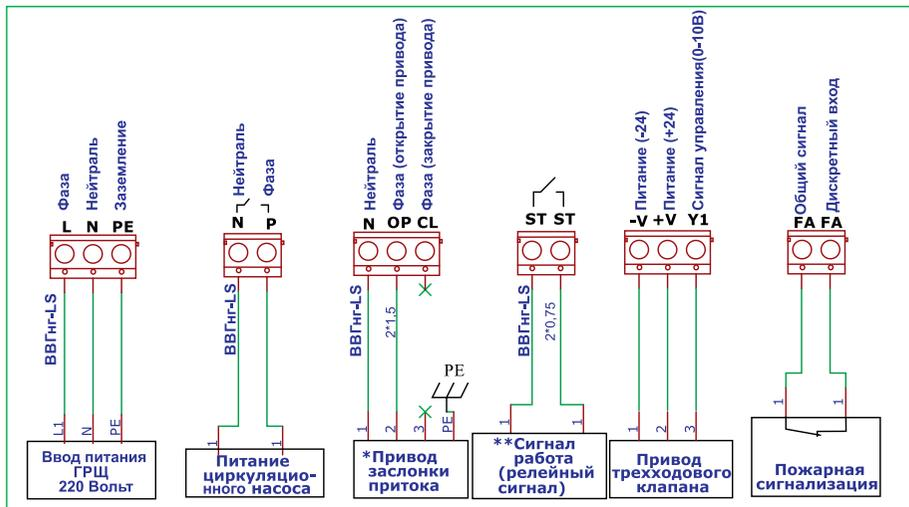
\* Пример подключения привода с возвратной пружиной. Для подключения приводов без возвратной пружины, предусмотрена клемма «CL».
